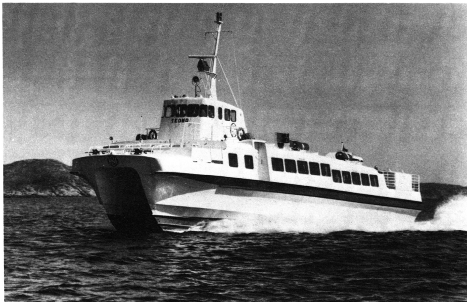
Westamaran fra Westermoen Hydrofoil AS 1973, hurtiggående passasjerskip med tvillingskrog. Konstruktør av båttypen, kommandørkaptein Harald Henriksen fikk i 1973 NTNFs ærespris.
