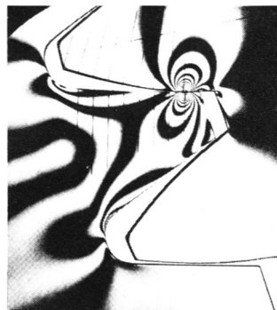
Fotoelastisk spenningsmåling i tannhjul ved hjelp av polarisert lys og plastmodeller. SINTEF.
